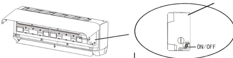
Il peut être utile si la télécommande ne fonctionne plus, pour allumer ou éteindre le climatiseur.
