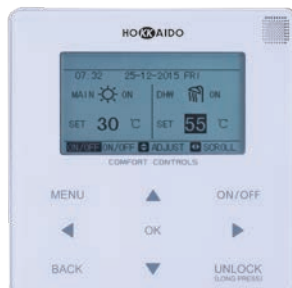
Mode de fonctionnement CHAUFFAGE + ACS
